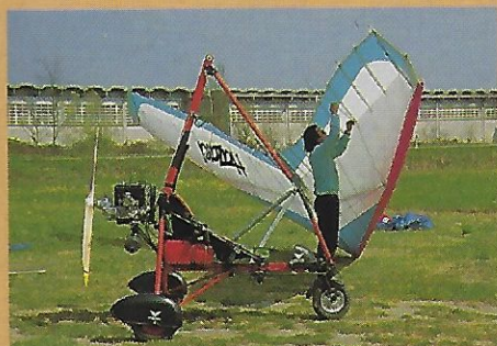
Inserimento stecche nell'intradosso: 3'
