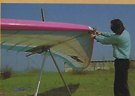
Fissaggio tiranti di prua: 2'
