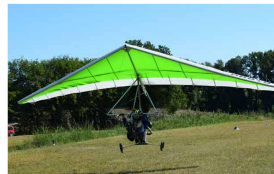
Con l'ala da 11 metri ci vogliono sempre 10 metri di più di corsa di decollo a parità di motore
