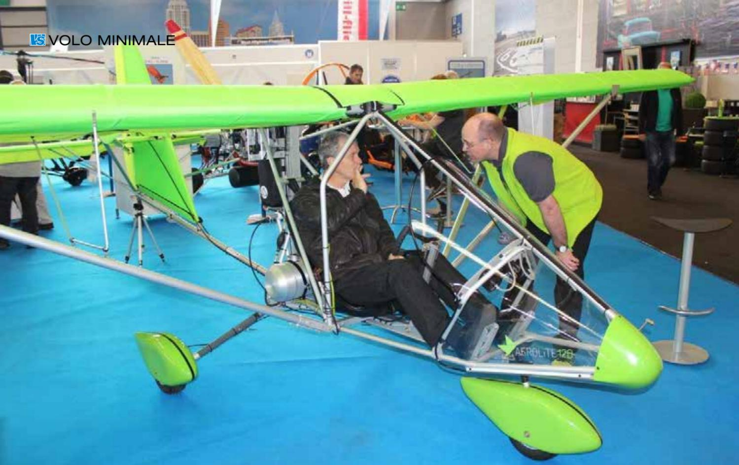
**L'Aerolite 120 propone il concetto di tubi e tela minimale, ma con una linea pulita e con una buona protezione del pilota**
