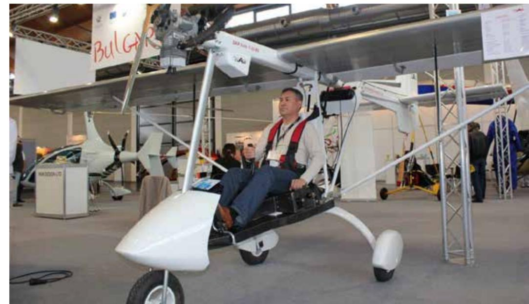
**Dalla Bulgaria questa proposta di Avio Design per un nanotrike in kit a basso costo, il Delta Truster con motore Simonini da 28 a 33 hp, e telaio completamente imbullonato**
